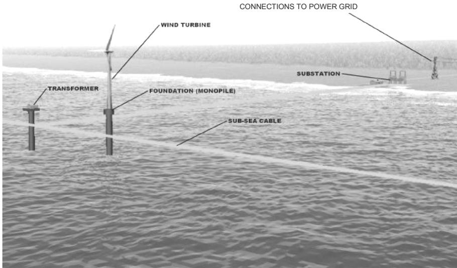
CONNECTIONS TO POWER GRID: 接入电网
