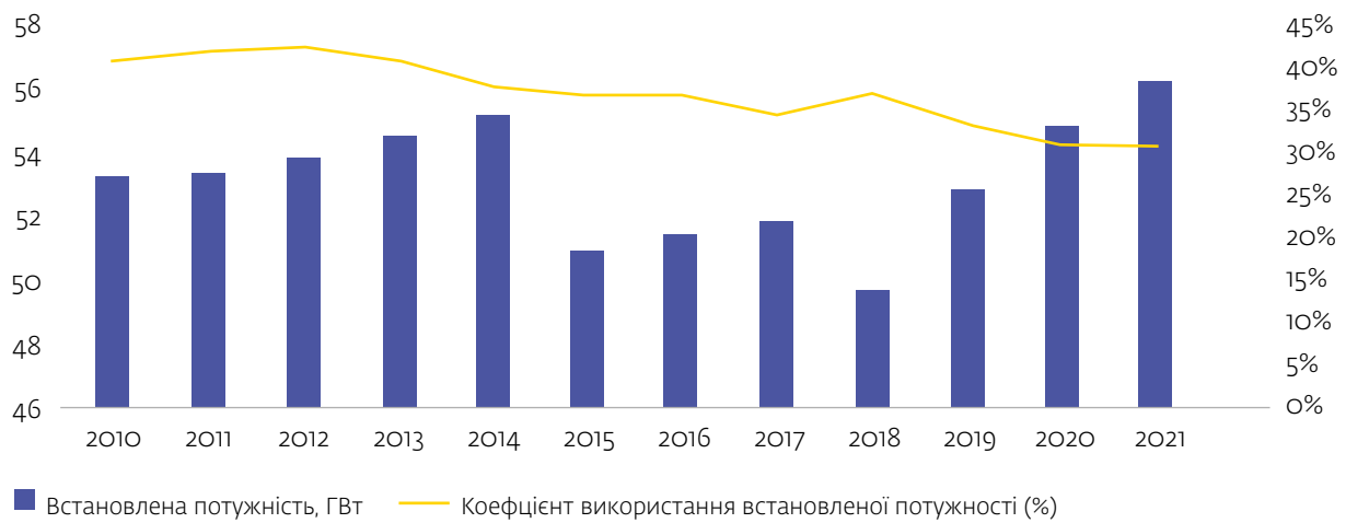
Рисунок А7.1 Історичний коефіцієнт використання встановленої потужності (%) та встановлена потужність (ГВт) електроенергетичної системи
